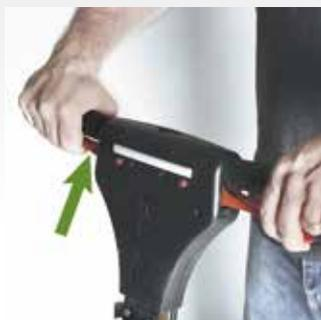
**Si la machine devient difficile à manœuvrer, relâchez la poignée de démarrage et la machine s'arrête immédiatement.**
