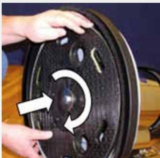
Installez le plateau Pad Drive et desserrez la vis centrale.
